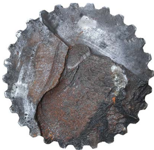
Przełom wału napędowego
