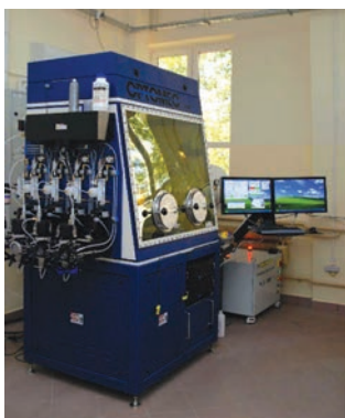
System LENS – laserowe kształtowanie przyrostowe (opracowanie własne)
