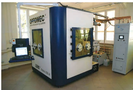
System LENS 850R wyposażony w laser włóknowy o mocy 1000 W: a) widok ogólny, b) głowica ze stołem uchylno-obrotowym
