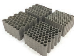
Cienkościenne tytanowe struktury komórkowe typu „plaster miodu” (opracowanie własne)
