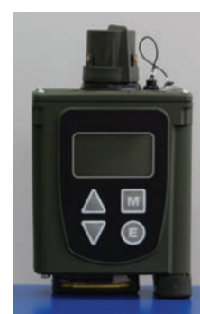
Miniaturowy spektrometr ruchliwości jonów przeznaczony do wykrywania bojowych środków trujących
