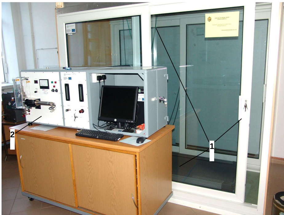
Fot.1. Aparatura do badania całkowitego przecieku wewnętrznego z użyciem NaCl 1-komora badawcza z bieżnią i układem rozprowadzania NaCl; 2-fotometr z układem pomiarowym i sterowania
