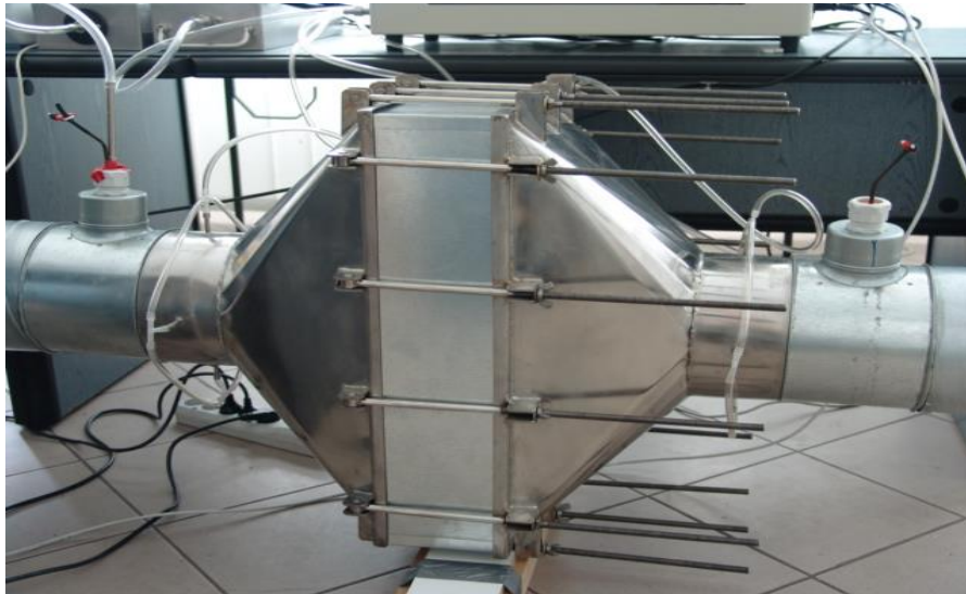
Ryc. 22. Badany filtr klasy HEPA w uchwycie
