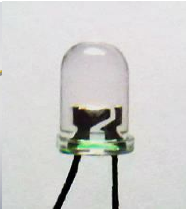
Rys. 6b Układ elektrod w diodzie LED po lewej stronie katoda, po prawej anoda.
